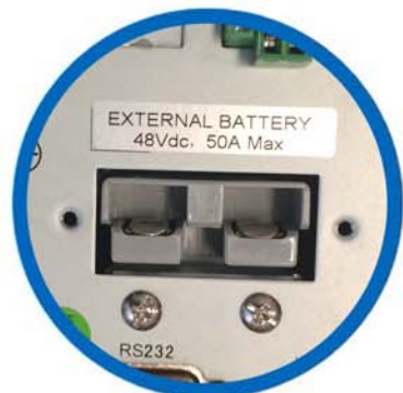
Entrada banco de baterías externas
