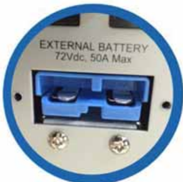
Entrada banco de baterías externas
